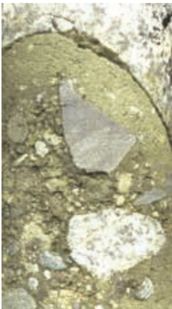
Abb. 26a: Teil einer Zwickelfüllung aus Granodiorit, Grauwacke sowie Lapilli und einer Matrix aus Asche.
