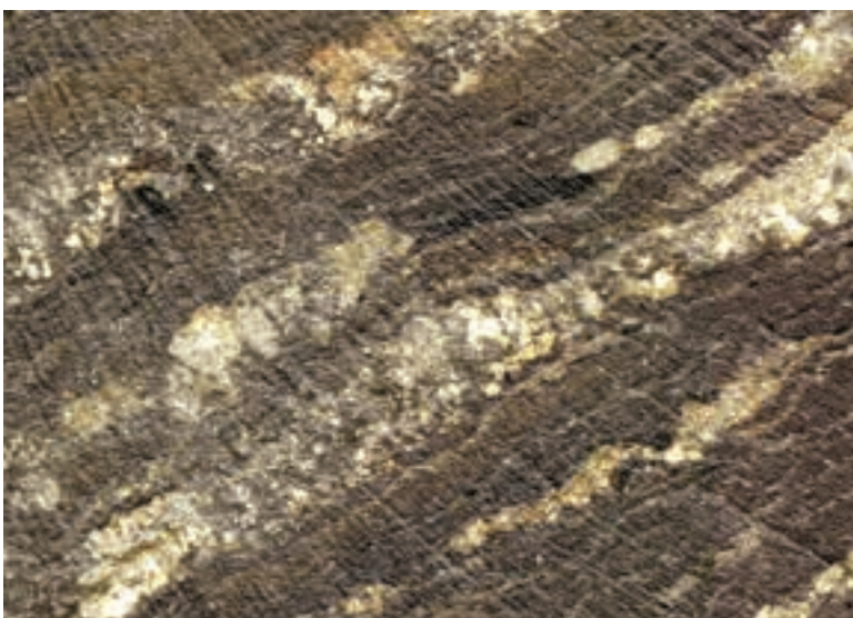
Abb. 31a: Dunkler Feinsand mit Lagen aus Granodioritgrus.
