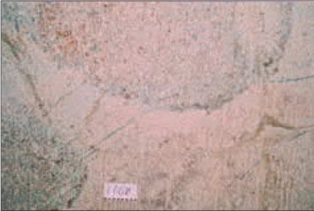
Abb. 10: Station 1768 m - Kontakt zwischen den Granittypen 2 (rechts unten) und 3 (links oben); Maßstab in Zentimetereinteilung
