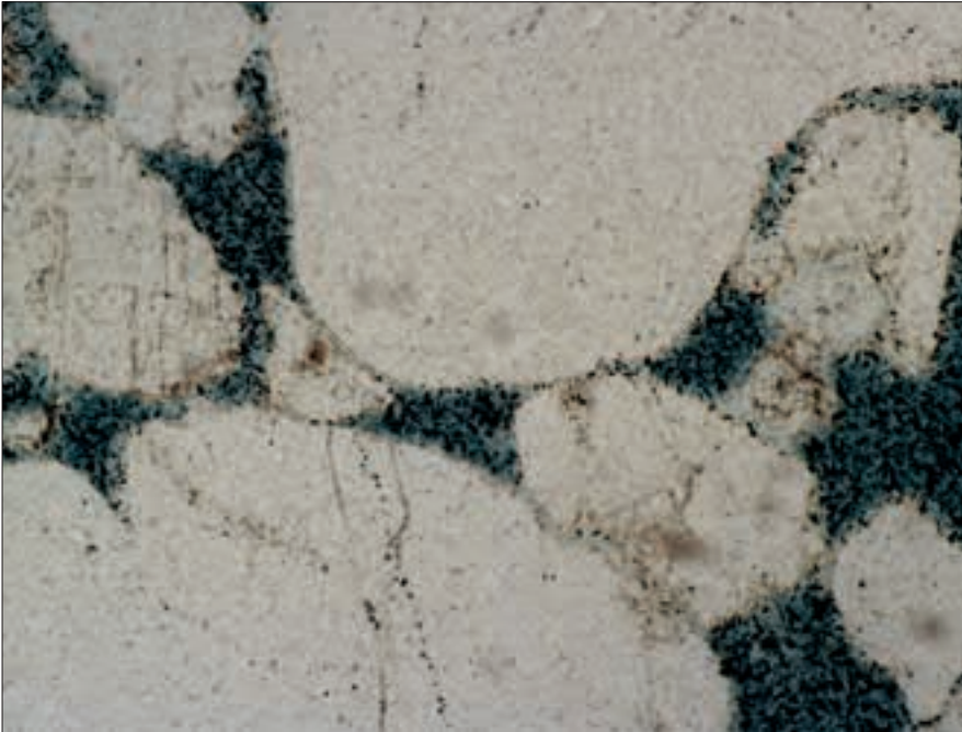
Abb. 7: Sandstein aus der Ablösungsfläche vom Felssturz Wartturm Sächsische Schweiz. Der Porenraum wurde zur besseren Unterscheidung blau gefärbt. Präparationsbedingt erscheint der Porenraum jetzt schwarz gefleckt. Zu erkennen ist, dass sich die einzelnen Quarzkörner nicht mehr in festem Kontakt zueinander befinden. Durch Lösungsprozesse ist das kieselige Bindemittel nahezu vollständig abgebaut. Dies war mit ein Grund für die Entfestigung des Felsmassivs und für den Felssturz. II Nicols, Bildausschnitt 1,0 x 1,4 mm.
