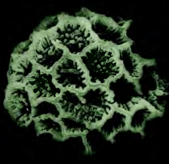
▲ Neugebildeter Gips aus feinkörnigen Ablagerungen, Bohrung, 325 m Tiefe, Innviertel, OÖ; Vergrößerung ca. 2300×
