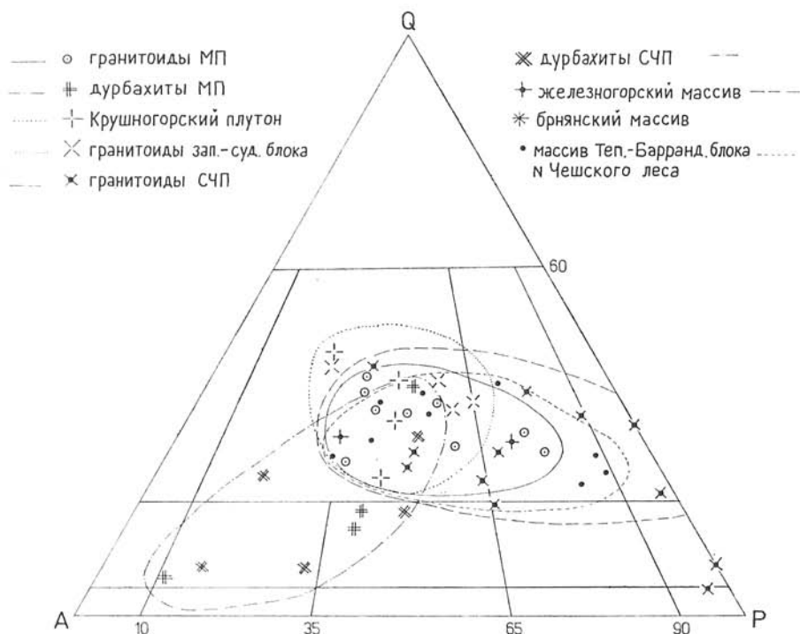
Рис. 5. Ведущие типы гранитоидов Чешского массива по классификации Штрекайзена (IUGS — на основании главных гранитоидных массивов или областей). Характер мафитов можно определить по данным на рис. 2. Список анализов приведен в таб. 1.
