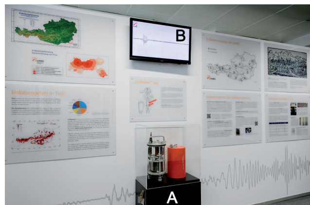
FIG. 2: Il settore relativo alla sismica alla mostra geoscientifica dell'Istituto di Geologia dell'Università di Innsbruck: saltando si genera un "terremoto personale" che viene registrato dal sismografo (A) e la cui magnitudo viene mostrata sullo schermo (B). Alcuni pannelli forniscono informazioni sugli aspetti generali della sismicità in Austria
