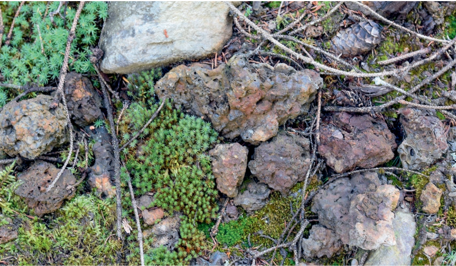
ABB. 1: Prähistorische Kupferschlacke an der Oberfläche des Waldbodens am Schmelzplatz SP 2 bei Stilfs (Foto: Koch Waldner) FIG. 1: Prehistoric copper slag on the surface of the forest ground at the smelting site SP 2 near Stilfs. (Photo: Koch Waldner)
