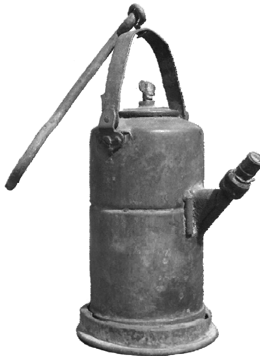
Abb. 7: Acetylen-Lampe (Modell 5000 von Otto SCHARLACH, Nürnberg), gefahren um 1905 im Blei-Zink-Bergbau von Arzberg–Haufenreith.
