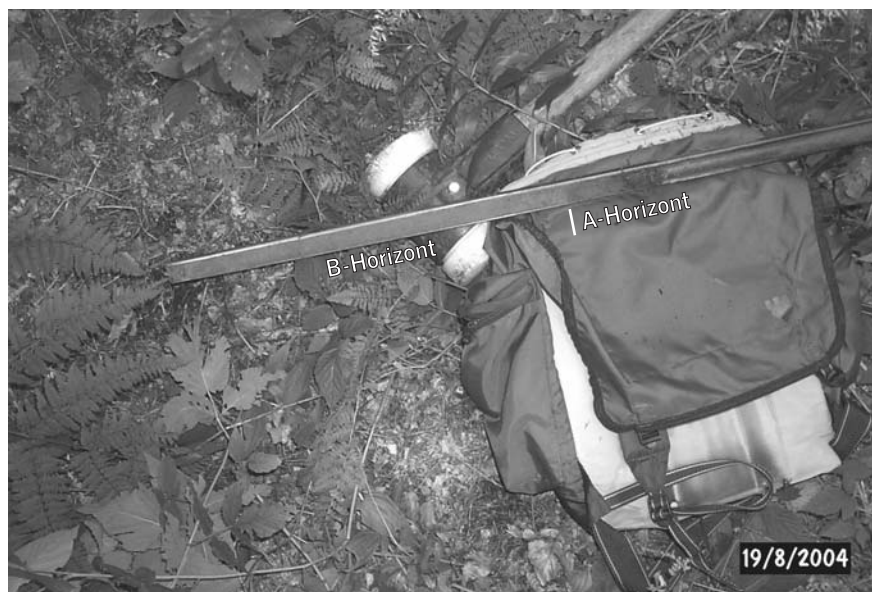
Abb. 2: Probennahmestock nach Pürckhauer, Hammer mit Kunststoffkopf. Erkennbar: ca. 15 cm Humus (A-Horizont), darunter ca. 60 cm Boden (B-Horizont).
