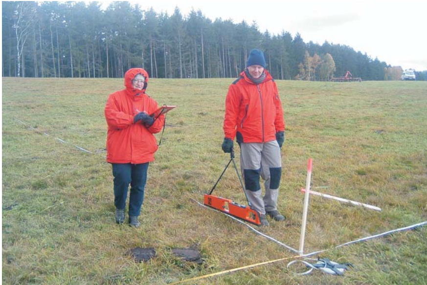
Elektromagnetische Prospektion mit EM38. Electromagnetic prospecting with EM38.
