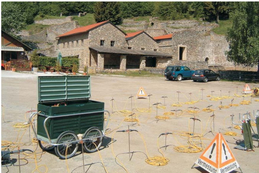
Multielektroden-Geoelektrik. Multielectrode geoelectric investigations.
