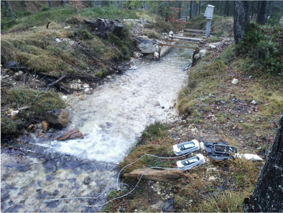
Abbildung 9: Messungen 4 bis 14 erfolgten im nicht-rückstauenden Bereich. Auf der unteren Bildhälfte sind die Leitfähigkeitssonden (TQ-Amps) zu sehen. In der oberen Bildhälfte die Messstation des Hydrographischen Dienstes Tirol direkt an der Holzrinne.
