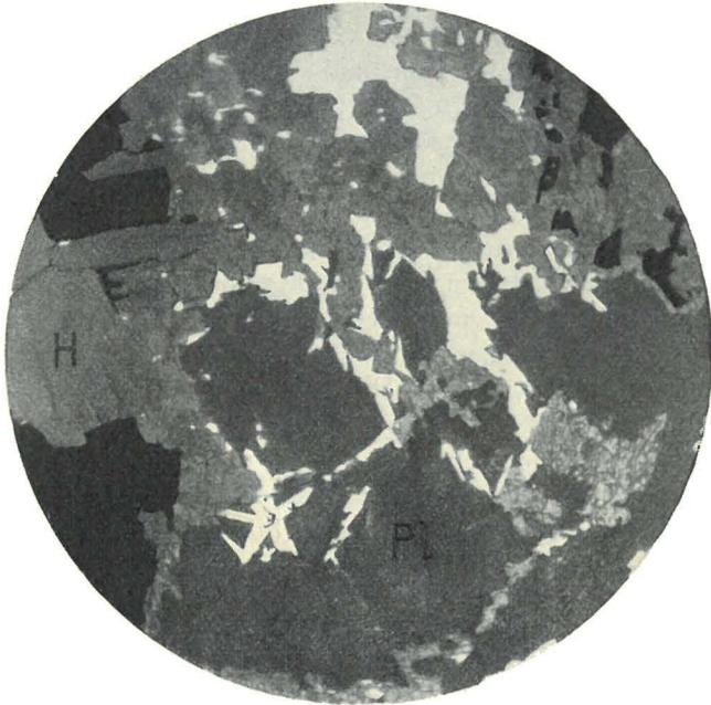
Fig. 3. Pleonast, von Högbomit und Hydrargillit durchsetzt. Mutung »Perseus«, Ruoutevare.
