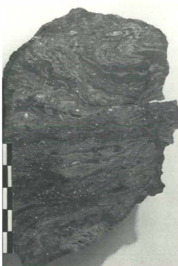
Abb. 9: Heller, bimssteinähnlicher Hyalomylonit (Entgasungsblasen) mit Schlieren von dunkler, ungeschmolzener Mikrobrekzie, Maßstab = 5 cm. Orientiertes Handstück aus der sekundären Gleitfläche, Aufschluß am westseitigen Hangfuß im Dranglung-Tal, 4000 m Seehöhe.
