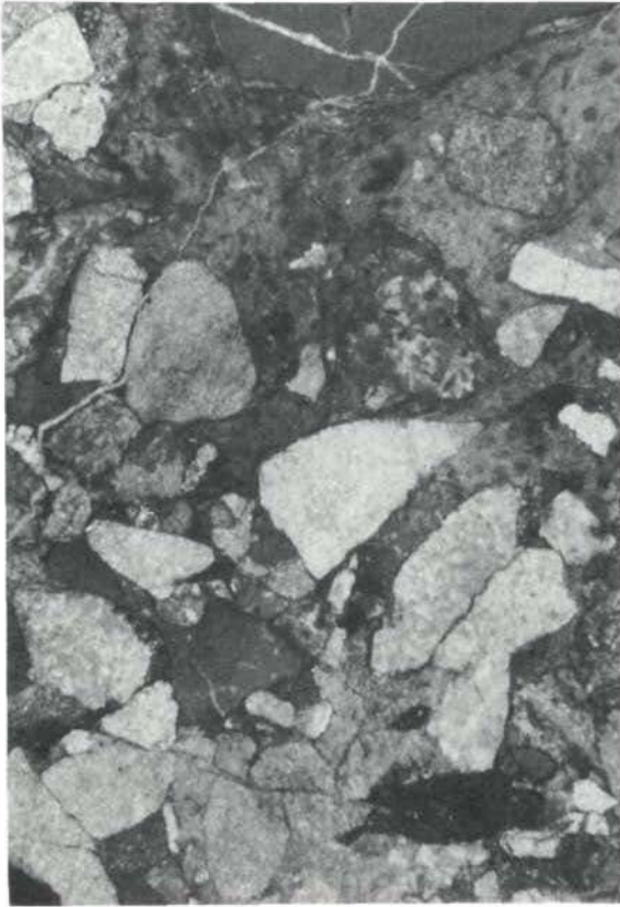
Foto 2: Breccie Schindeln mit Dolosparitkomponenten; x 6
