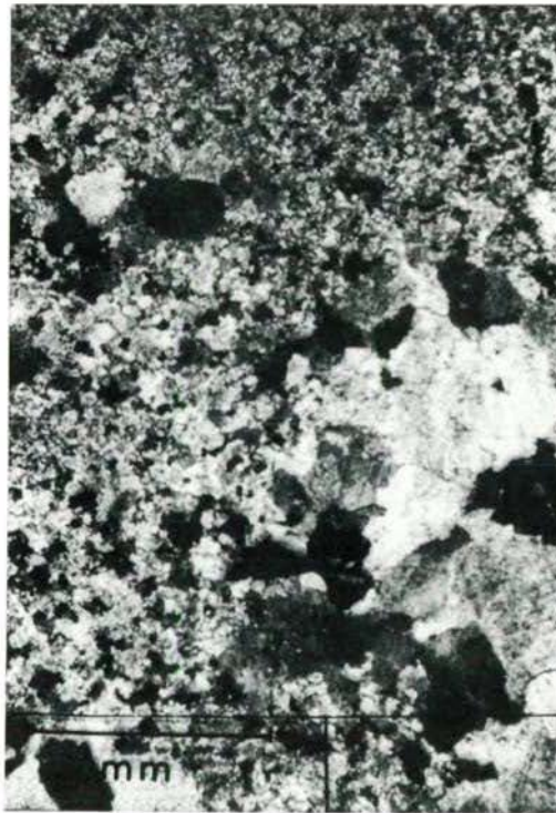
Abb. 10: Dünnschliffbild der Probe PW 6 (mittelostalpiner Dolomit), + Nicols
