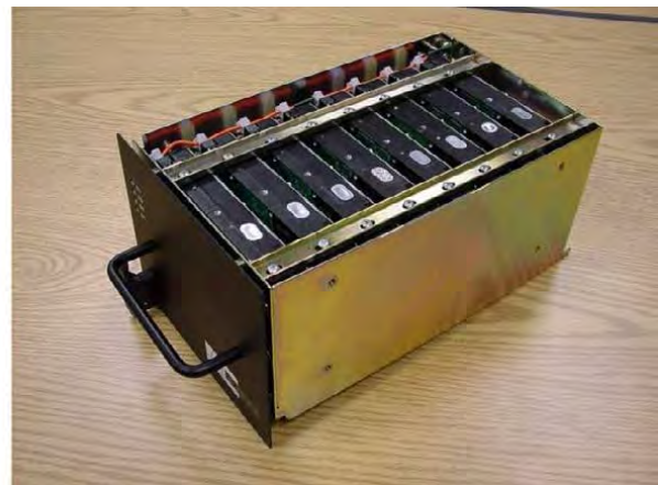
Abb. 2-4: Mark V Prototypgehäuse und „8-pack“ Modul ( http://web.haystack.mit.edu/mark5/ ).
