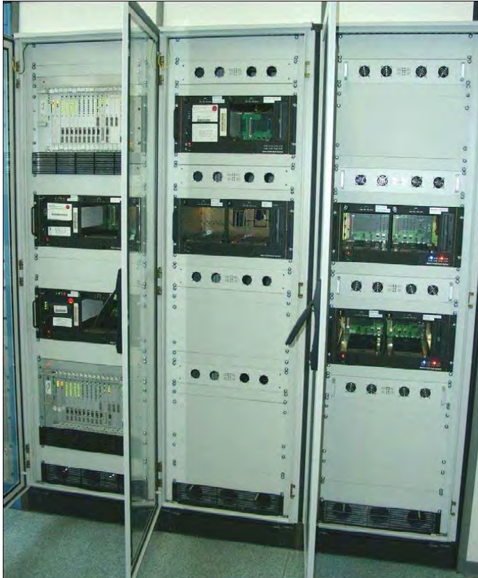
Abb. 2-5: Der Korrelator am Max-Planck-Institut für Radioastronomie, Bonn, Deutschland. Racks mit (v.l.n.r.): zwei Station Units (SU) + zwei Mark 5A, zwei Mark 5A + Platz für correlator interface boards (CIB) sowie zwei Mark 5B + Platz für CIB. (Foto aus Alef et al., 2007)
