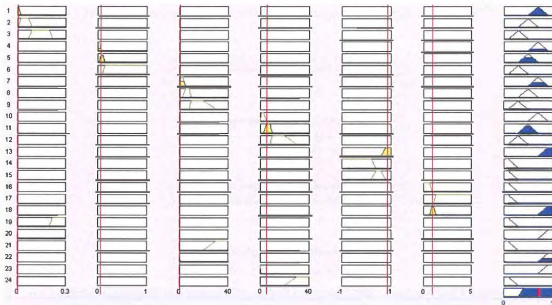
Abbildung 4.15: Inferenz, Aggregation und Defuzzifizierung in der Matlab Fuzzy Toolbox am Beispiel des ersten Fuzzy Systems.
