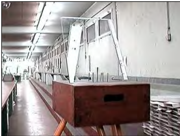
Abb. 5-15: Die Aufstellung der Glasplatte auf dem Stativ
