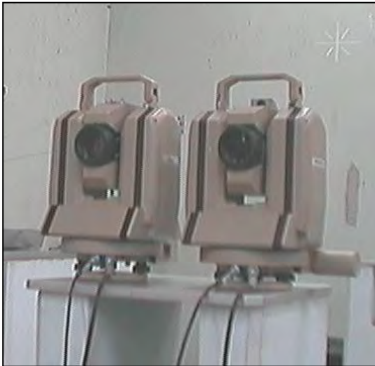
Abb. 5-8: Einseitige (parallele) Aufstellung der Instrumente
