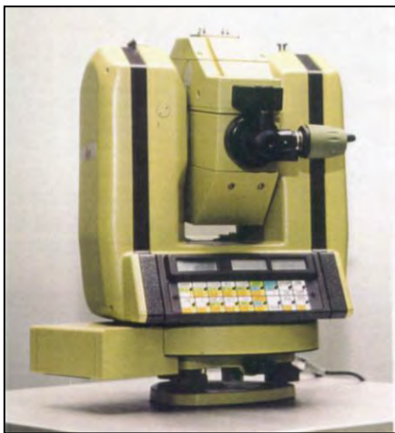
Abb. 4-2: Fernrohrkörper des Videotheodoliten Leica TM3000VD ( Leica, 1991 )
