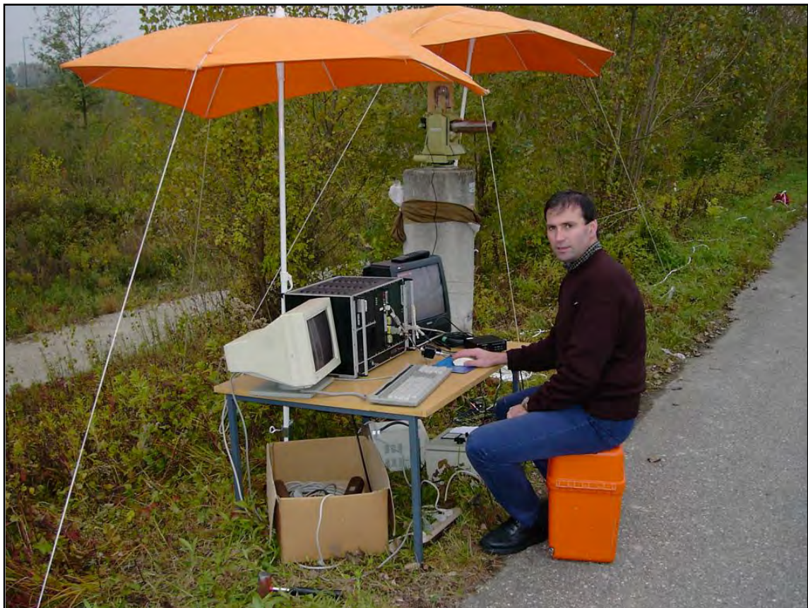
Abb. 7-3: Versuchsaufbau: Steuerrechner, Videotheodolit (Photo: Dr. Retscher)
