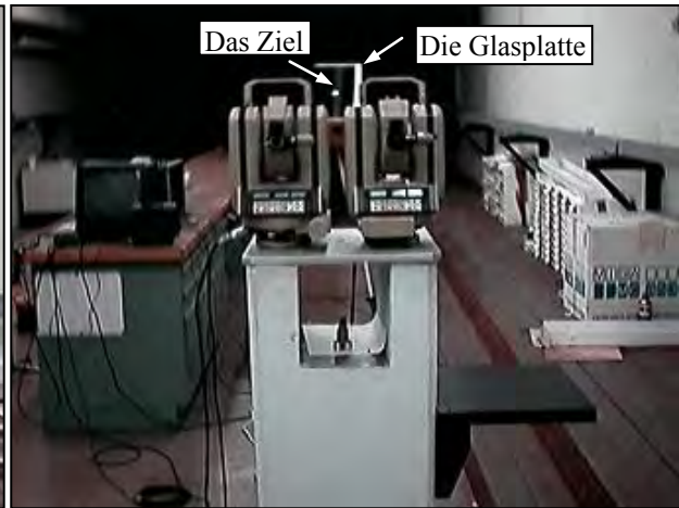
Abb. 5-16: Einseitige Aufstellung der Videotheodolite
