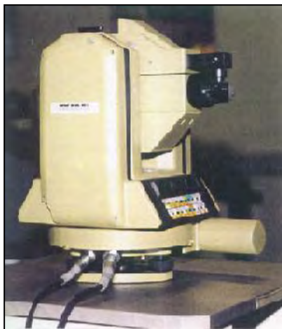
Abb. 4-1: Videotheodolit und Fernrohrkörper des Videotheodoliten Leica TM3000V ( Katowski, 1989 )
