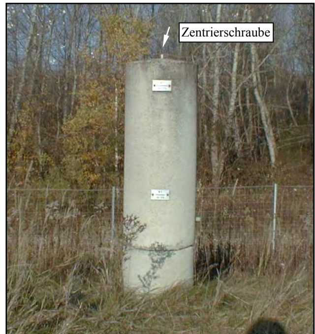
Abb. 7-46: Messpfeiler mit Zentrierschraube
