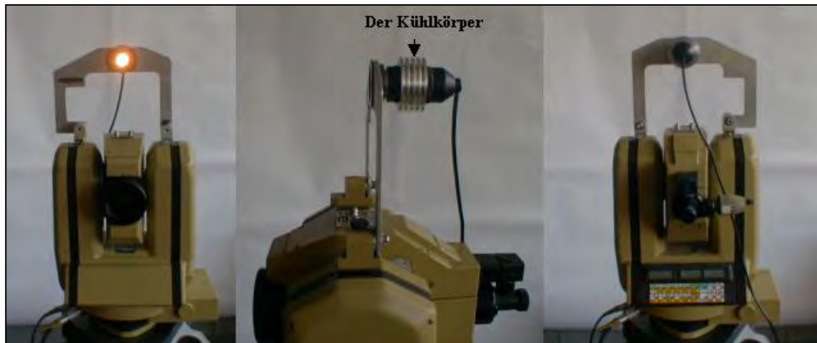
Abb. 4-8: Aufgeschraubter „Bügel mit Lampe“ auf dem Videotheodolit
