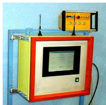
Abb. 7: Sensor und Steuereinheit zur automatischen Verschiebungsmessung
