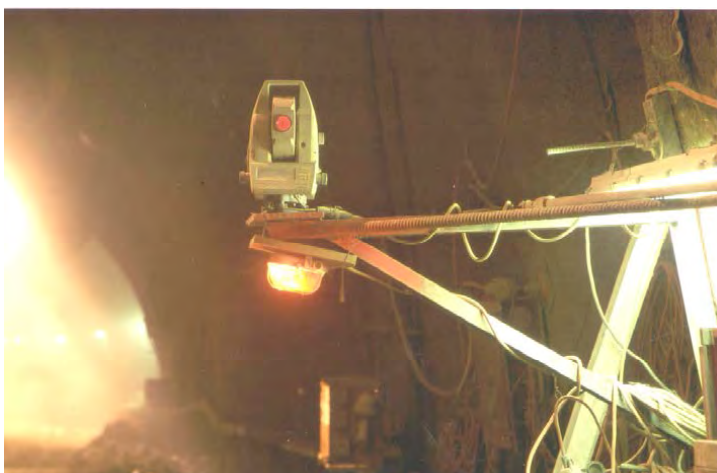
Abb. 7: Sensor und Steuereinheit zur automatischen Verschiebungsmessung
