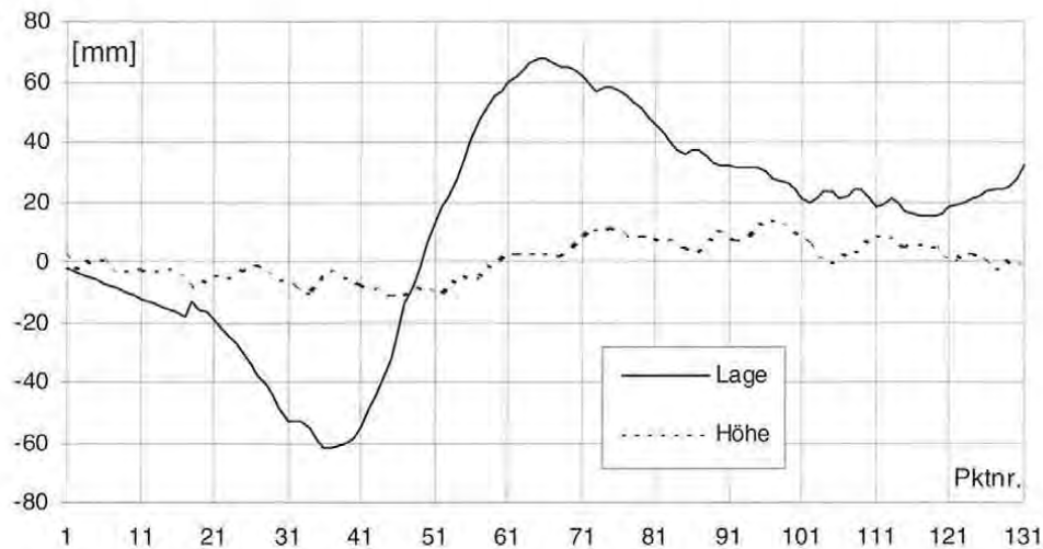
Abb. 4.1: Abweichungen der mit einem Meßroboter aufgenommenen Meßwertreihe TH282.MES in Lage und Höhe von der Solltrasse TREND1.ETR
