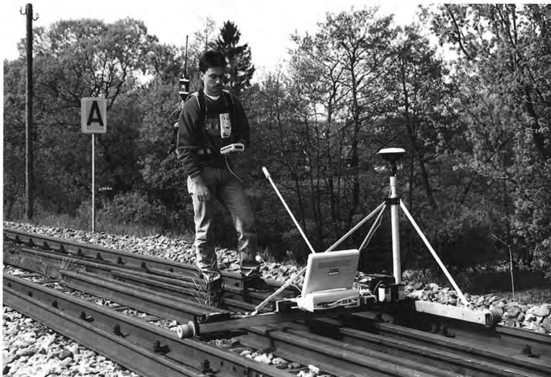
Abb. 5.3: Gleisaufnahme mit einem GPS-Echtzeitvermessungssystem
