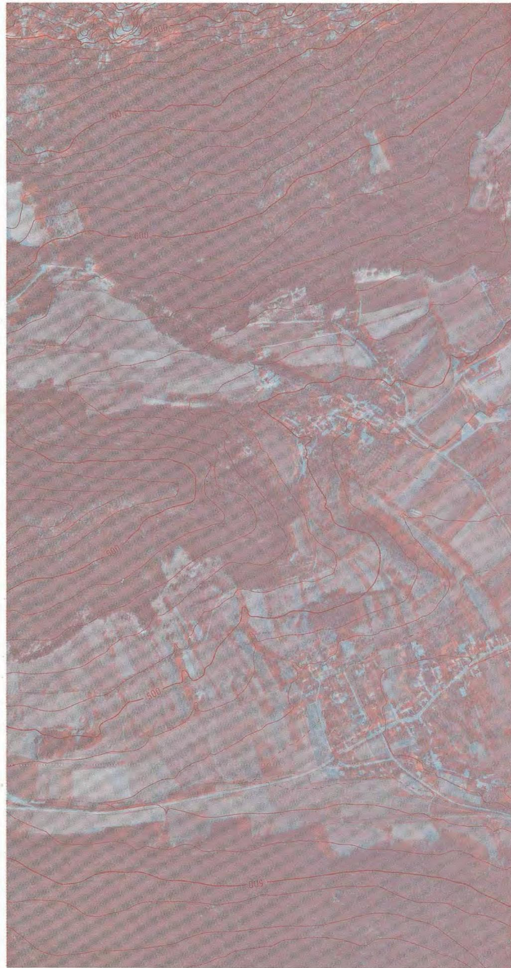
**Stereo-Orthophoto „Hohe Wand“ 1:10 000 mit analog ausgewerteten Höhenschichtlinien.**
