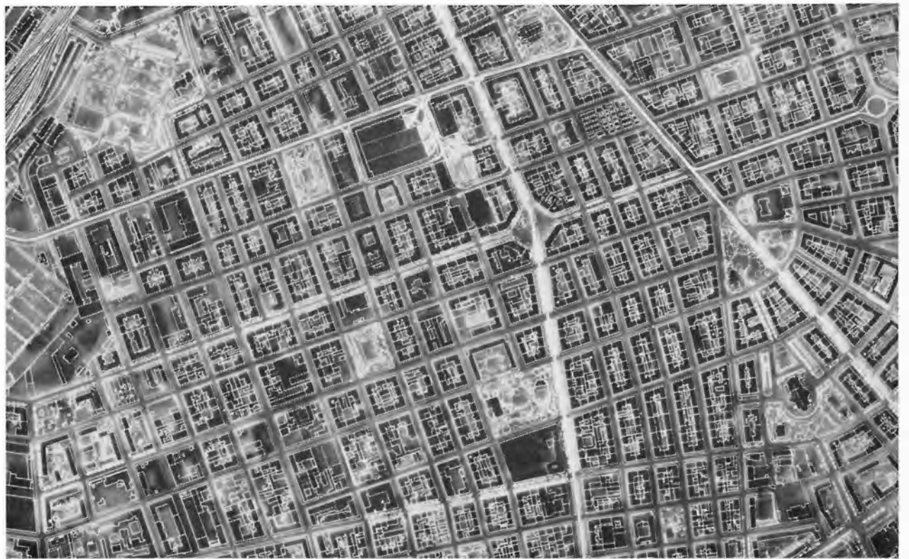
Abb. 4: Ausschnitt der Zusammenkopie des rektifizierten MSS-Bildes (Beispiel Nr. 5 der Tabelle 3) mit der Situationsdarstellung der Wiener Stadtkarte im Maßstab 1:10 000.
