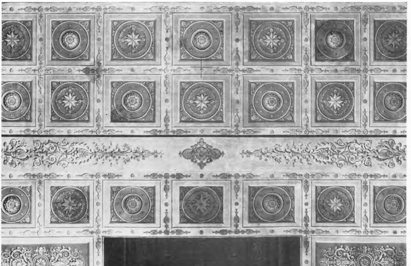
Bild 2: Photographische Entzerrung im Maßstab 1 : 50 mit dem Wild Avioplan OR I (ausgeführt vom Institut für Photogrammetrie der TU Wien).
