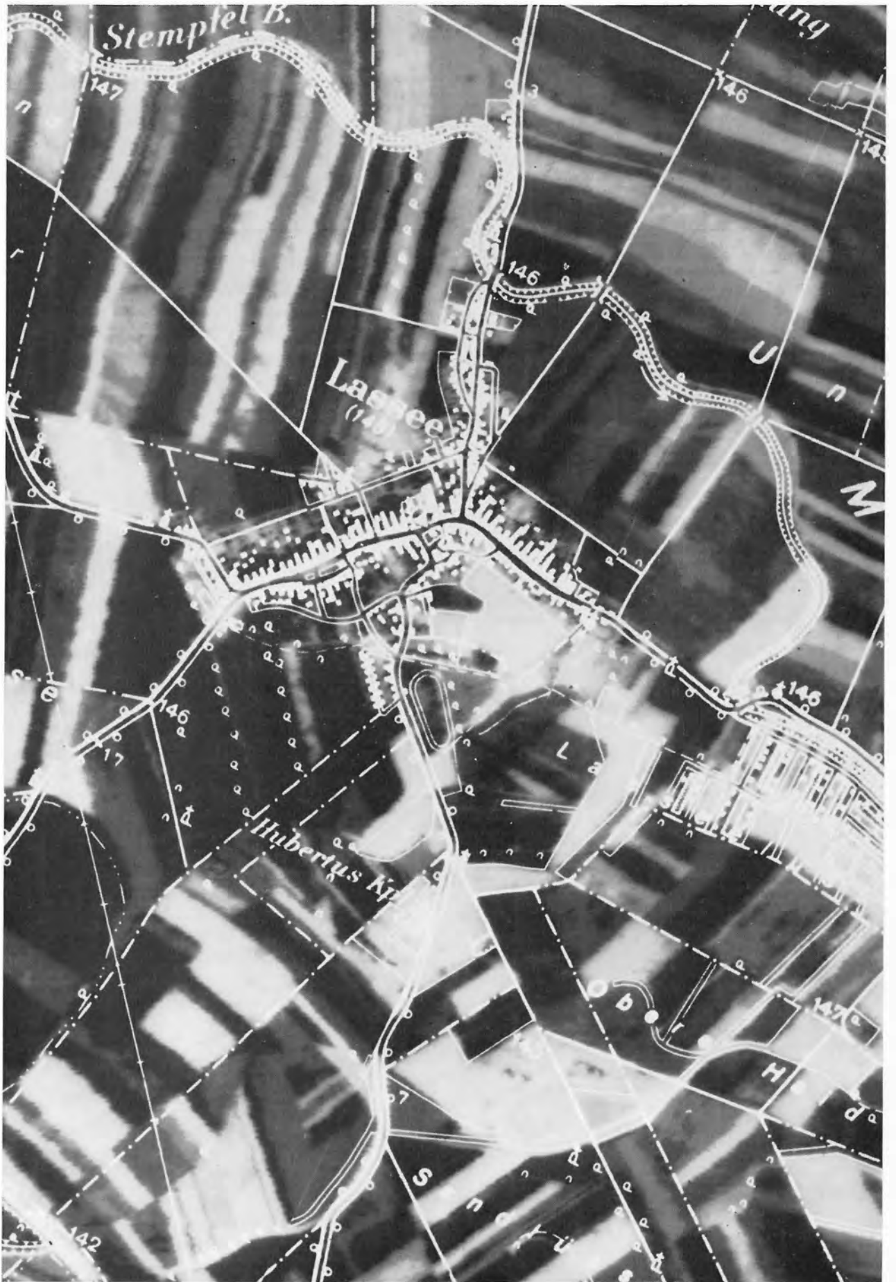
Abb. 1: Ausschnitt der Zusammenkopie des rektifizierten MSS-Bildes (Beispiel Nr. 1 der Tabelle 3) mit der Situationsdarstellung der Österreichischen Karte (ÖK 1:50 000) im Maßstab 1:20 000.
