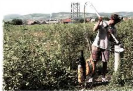
Einbau der Probenahmepumpe Mittels Doppelpacker
