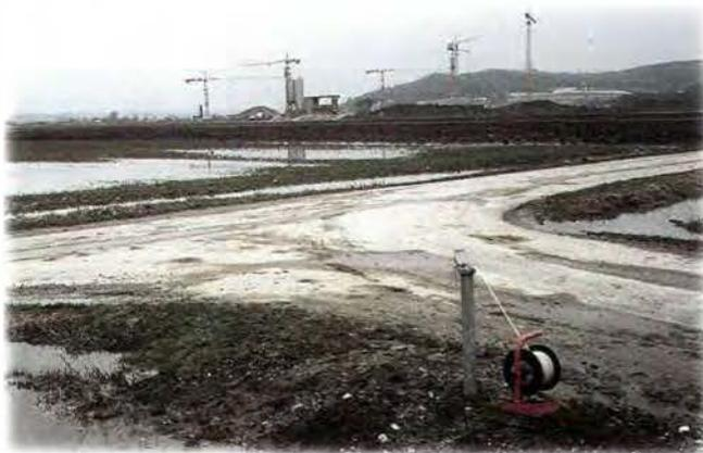
Grundwasserspiegelmessungen bei der EU-Lyocell Baustelle im unteren Lafnitztal.
