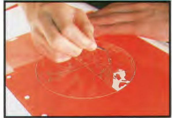
▲ Maskenherstellung, Negativ gestrippt
