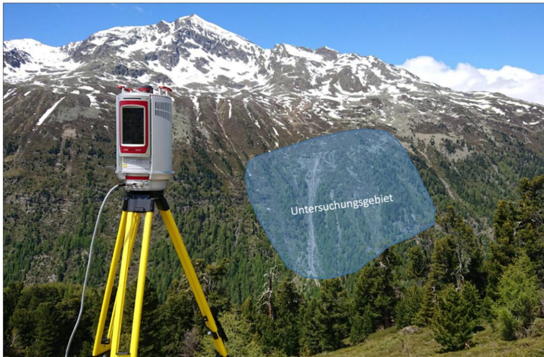
**Abbildung 2:** Ansicht des Untersuchungsgebiets mit mobilem Scanner Riegl VZ-4000.
