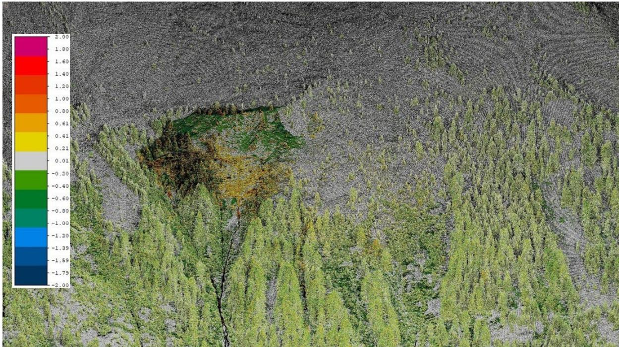
**Abbildung 3:** 3D-Ansicht der Distanzen zwischen den Punktwolken der Epochen 01.08.2019 und 15.10.2019 (mobiles Scan-Setup).
