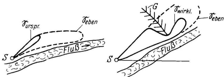
Abb. 9. Ursprüngliches ebenes und wirkliches Diagramm eines Senders
