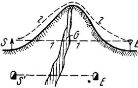
Abb. 59. Direkte und umlaufende Welle
