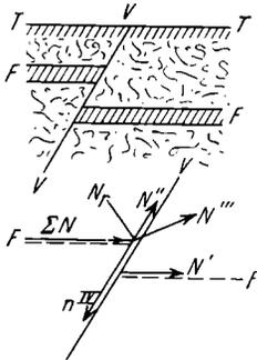
Abb. 37. Energiebilanz entlang eines Verwerfers
