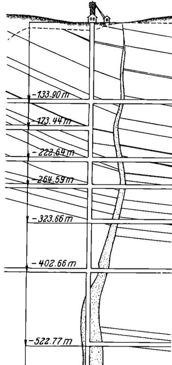
Abb. 49. Schnitt durch einen Versuchsschacht in Schlesiſch-Ostrau
