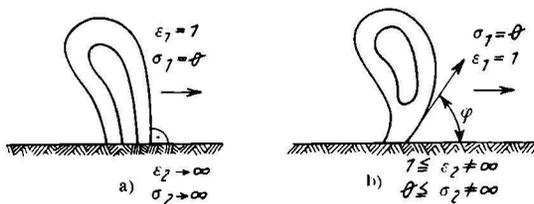
Abb. 5. Elektrisches Feld über gut und schlecht leitendem Untergrund
