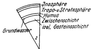
Abb. 20. Geoelektrisches Erdmodell
