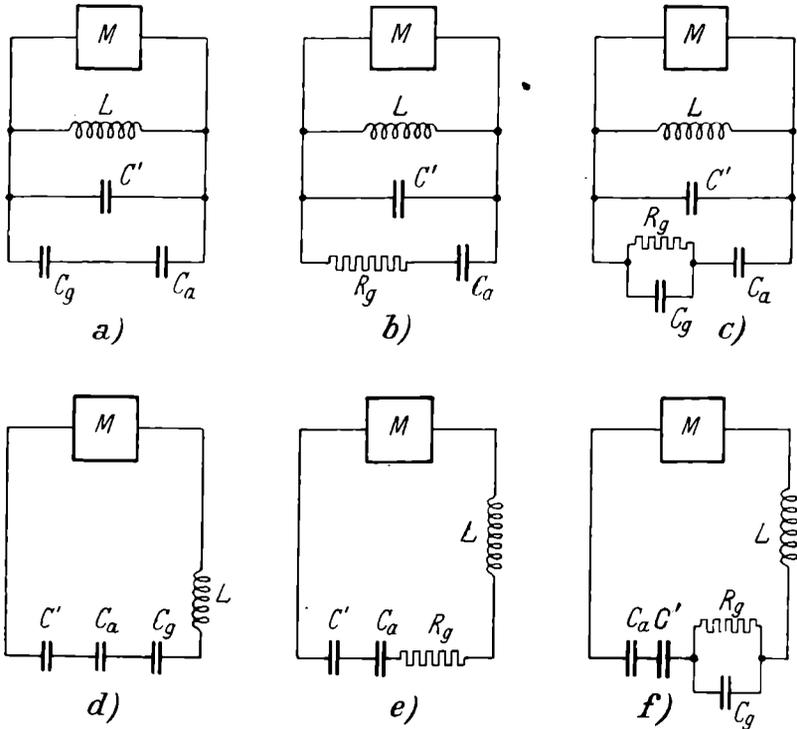
Abb. 70. Ersatzschemas für Meßantennen
