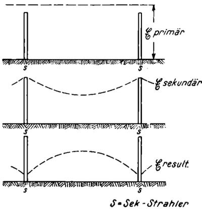
Abb. 13. Einfluß von Sekundärstrahlen
