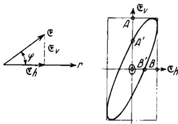
Abb. 6. Aufspaltung des Feldes in eine horizontale und vertikale Komponente
