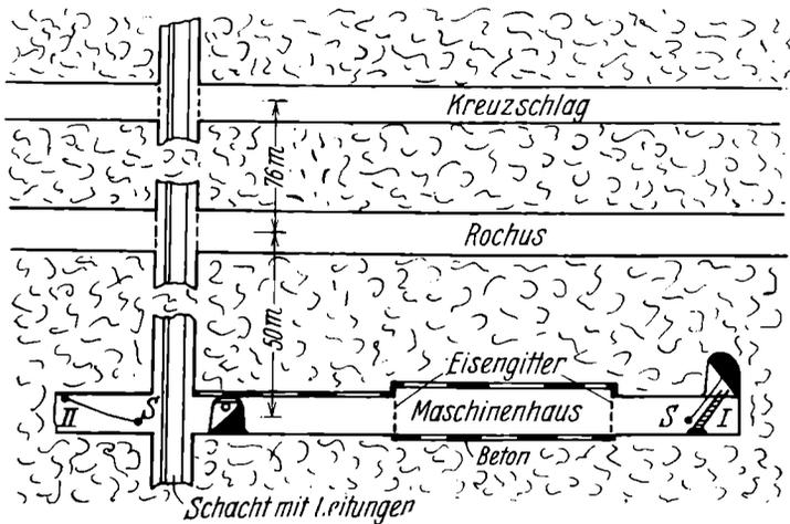
Abb. 84. Schnitt durch die Strecken in der Umgebung des Kreuzschlagschachtes in Kotterbach
