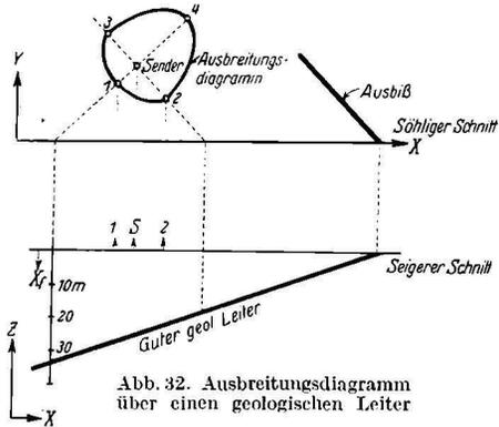
Abb. 32. Ausbreitungsdiagramm über einen geologischen Leiter
