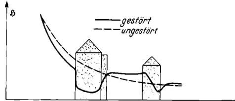
Abb. 12. Störung des Feldes durch Häuser
