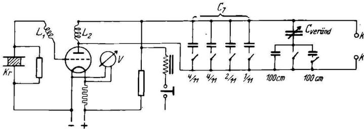
Abb. 74. Schaltschema für das Meßgerät nach der Reißmethode
