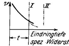
Abb. 53. Einfluß der Frequenz auf den Widerstand
