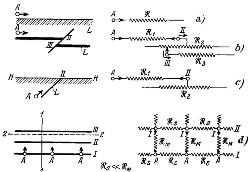
Abb. 27. Ersatzschemas für den Untergrund
