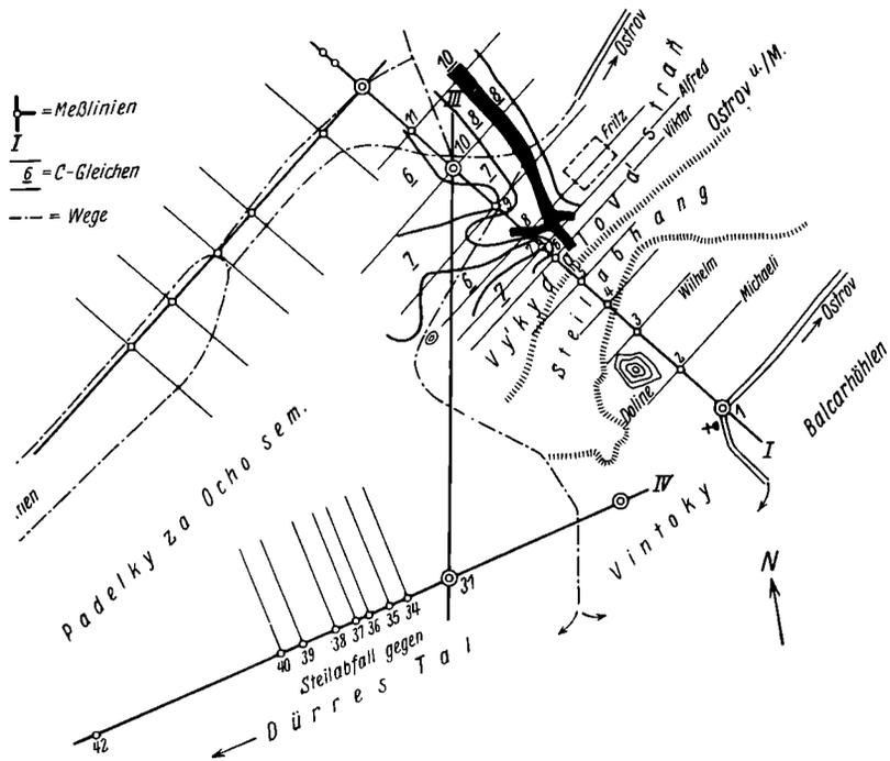
Abb. 80. C-Gleichen über einer Verwerferspalte
