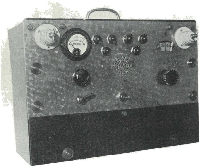
Abb. 75. Meßgerät nach der Reißmethode
