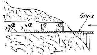
Abb. 31. Richtungsänderung der elektrischen Feldstärke
