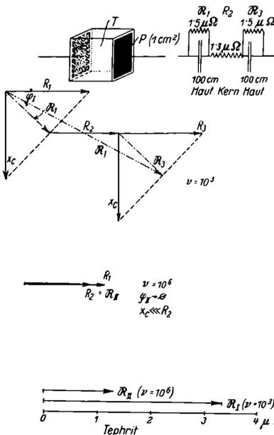
Abb. 17. Einfluß der Frequenz auf den komplexen Widerstand eines geologischen Leiters
