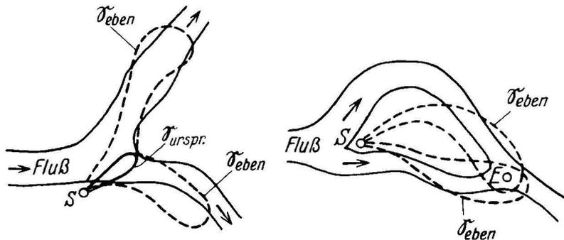
Abb. 40. Deformation eines Sendediagrammes durch einen Grundwasserstrom (oberer Arm) und ein Oberflächenwasser
