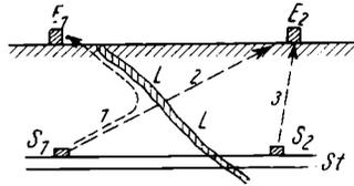
Abb. 85. Beeinflussung des Quellweges durch einen guten geologischen Leiter  $L$
