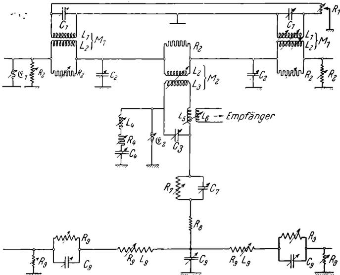
Abb. 42. Ersatzschema für einen Eisenbahnfunkempfänger
