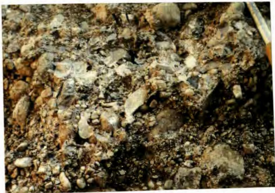
*Abb. 43: Basis der nordwestlichen Abbauwand; charakteristisch hoher Konglomerierungsgrad mit Bruch durch das Korn.*
