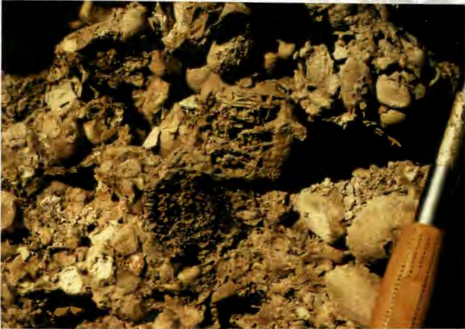
Abb. 49: Zementation der Einzelkörner und tiefgreifende Verwitterung, in der Bildmitte ein zersetztes Gneisgeröll.
