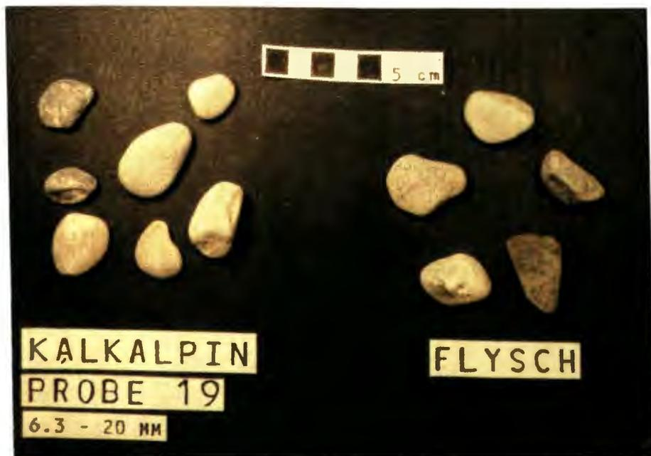
**Abb. 44:** Grube Fischböckau, Basis der nordwestlichen Abbauwand; Rundungsgrad der Mittelkiesfraktion von Probe 19.
