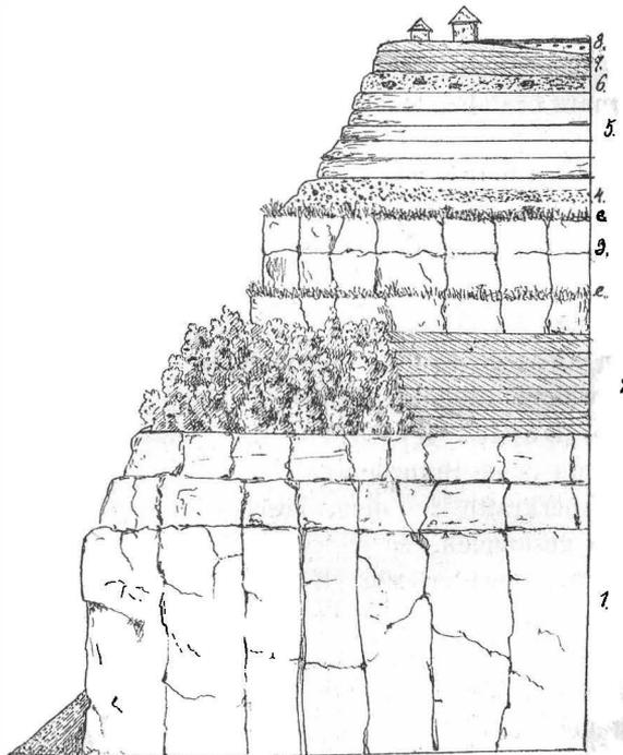
Fig. 12. **Profil unterhalb Kanina.** 1. Erster Kokořiner Quader. 2. Zwischenpläner. 3. Zweiter Kokořiner Quader. e, e Ericastreifen. 4. Conglomeratschichte des zweiten Kokořiner Quaders. 5. Trigoniaschichten. 6. Rostrother Sand. 7. Bryozoen-schichten. 8. Diluvium.
