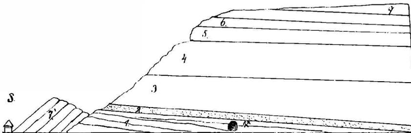
Fig. 33. Profil von Schirmdorf (S) auf die Anhöhe bei Pozucha in der Richtung gegen Leitomischel. 1. Perucer Schichten mit verlassenen Kohlenbau. 2. Glauconitschichten der Korycaner Schichten mit *Pect. asper*. 3., 4. Weissenberger Schichten. 5. Grane Letten mit *Terebratulina rigida* und zahlreichen Foraminiferen („u Kapličky“). 6. Byšicer Uebergangsschichten mit grossen grauen Knollen. 7. Trigoniaschichten mit Callianassen. 7' Trigoniaschichten am Fusse des Kozlovberges bei Semanín (S).
