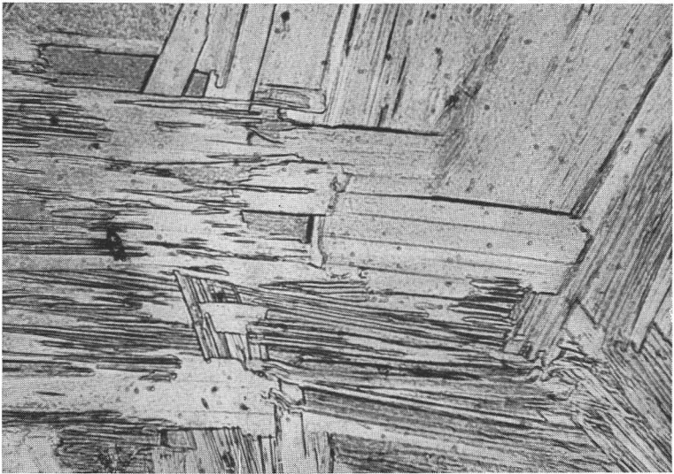
Abb. 2: Vergrößerter Ausschnitt aus der obigen zweiglimmerigen Pseudomorphose, aber im einfach polarisierten Licht. — Die Biotitlamellen erscheinen z. T. deutlich dunkler und haben die Lichtlinie innen gegenüber dem mit ihnen parallelverwachsenen Hellglimmer. — Vergrößerung 220 \times .
