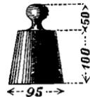
Hiernach würde eine centrale Belastung den Druck nicht vergrößern, wenn die Entfernung der Gewichtunterkante vom Boden etwa  $\frac{5}{3}$ mal so gross ist, als der Durch-
