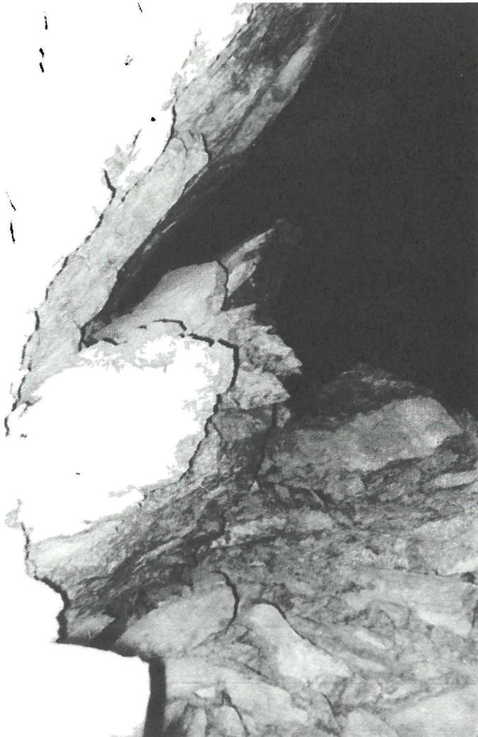
**Abb. 4: Spaltbruchmechanismus: Scharfkantige, scherbenähnliche Bruchstücke, splintern geräuschvoll ab.**
