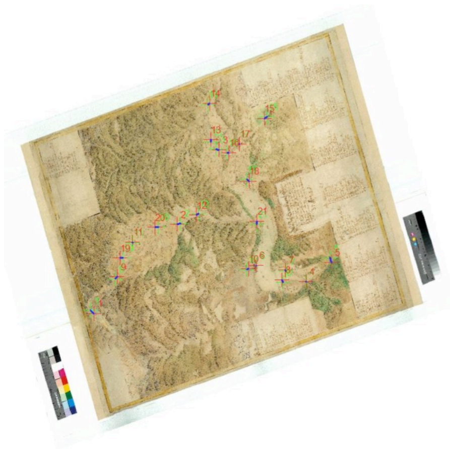
Figure 36: Riezinger 1743 (259a): Pass points used for georeferencing. Graphic: J. Klammer, Digital data: Oberösterreichisches Landesarchiv, Karten- und Plansammlung
