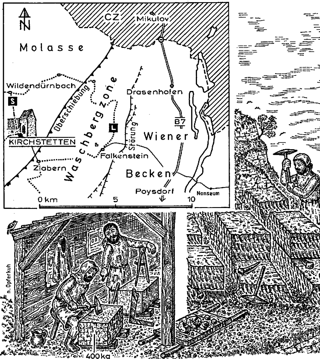
Abb. 21: Historische Steingewinnung und Bearbeitung am Beispiel des Leithakalks
