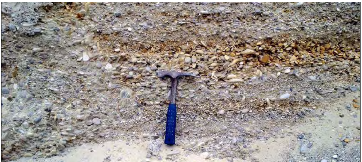
Abb. 4.18: Schotter des Sarmatiams in der Schottergrube südlich von St. Margarethen. Lithologisch handelt es sich um gut gerundete sandige Kiese mit lagig unterschiedlichen Sandgehalten
