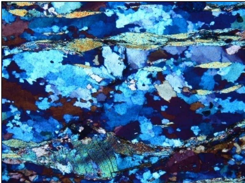
Abb. 38: Klar erkennbar ist die kristallographische Vorzugsorientierung, sowie die stark boudinierten Glimmer. (x Nicols und Gips, Bildbreite 6,3mm)
