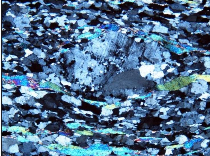
Abb. 37: Bei x Nicols ist der Sigma-Feldspat-Klast im Paragneis gut erkennbar, die rekristallisierten Quarz-Körner zeigen SGR. (Bildbreite 6,3mm)
