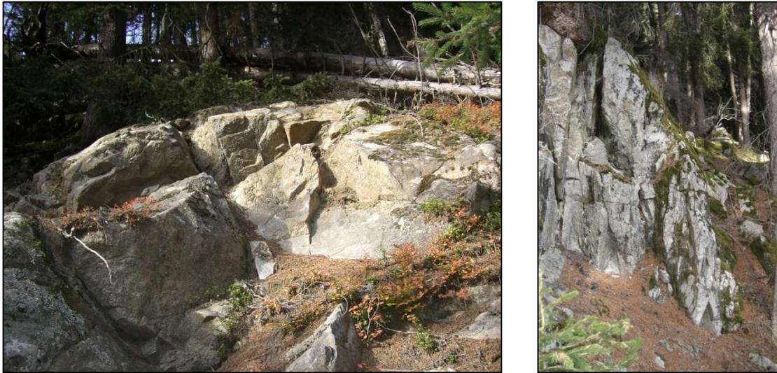
Abb. 125: Kompakte Bereiche wechseln mit einzelnen Bereichen, die stark aufgelockert sind
