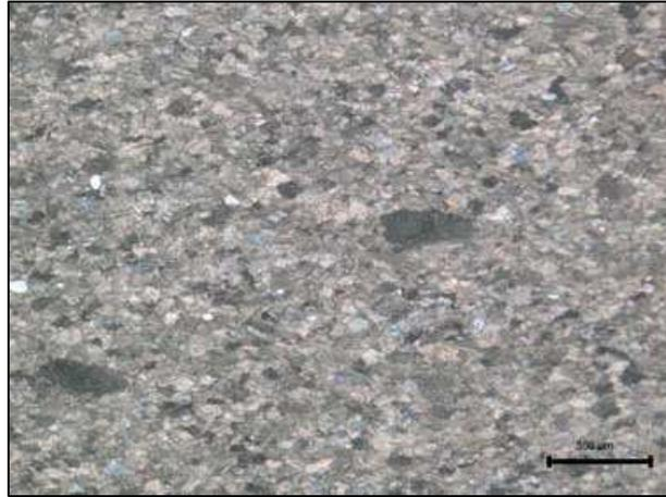
**Abb. 40: Sehr gleichkörniges Gefüge aus rekristallisiertem Quarz.**
