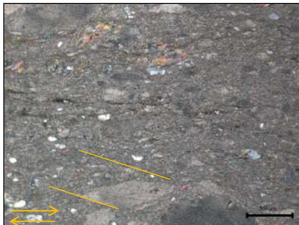
**Abb. 41: Feinkörnige, laminierte Kalzitmatrix mit Glimmerfischen und Quarzkörnern. Erkennbar sind des weiteren Scherbahnen (in Orange angedeutet).**
