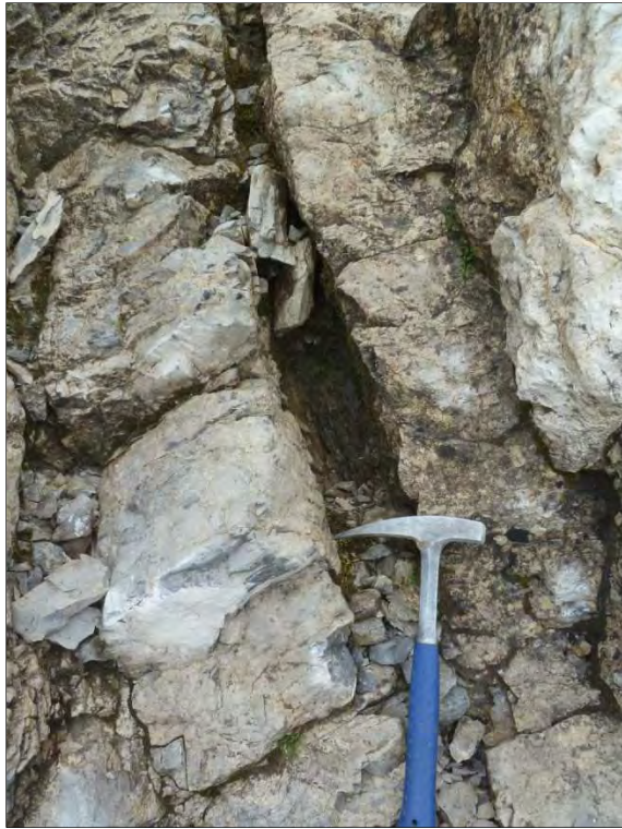
Abbildung 6: Wechselfolge von dm-gebankten, sparitischen Dolomiten mit Einschaltungen von cm-mächtigen Tonschiefern. Südlich der Bärenscharte
