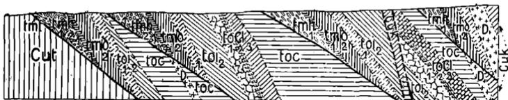
Fig. 2. Schematisches Profil der Lagerungsverhältnisse in dem Schuppensysteme der devonischen Kalkc an der Ense und an den Hauern bei Wildungen (ohne Berücksichtigung der Specialfaltung etc.).
