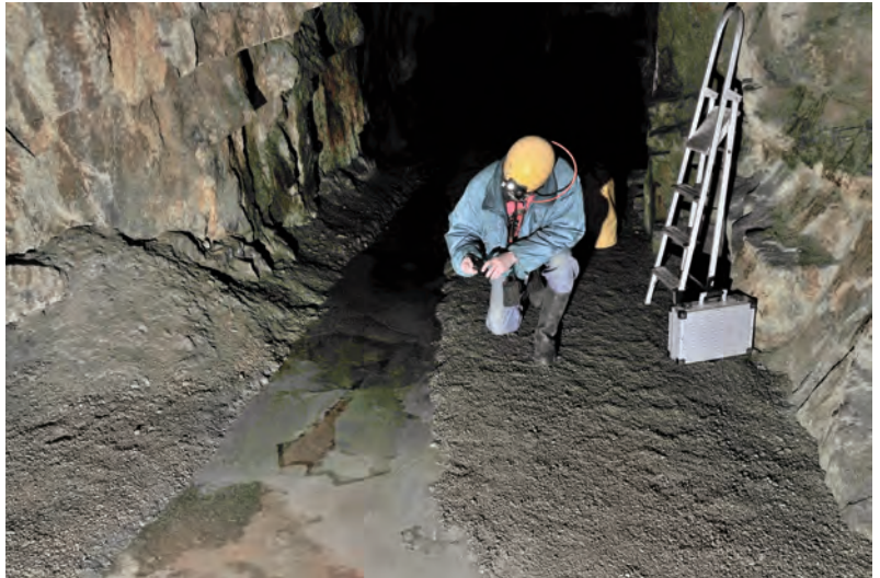
Abb. 19: Im Rückstaubereich des Abflussgerinnes nahe des MP 8 bilden sich an der Wasseroberfläche schwimmende Kalkplättchen. (Foto: H. Thaler).
