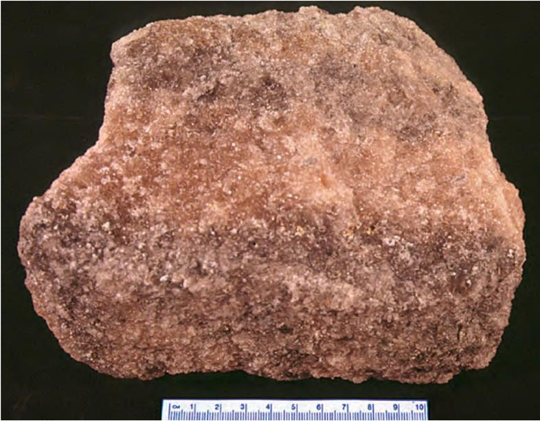
**Abb. 1:** Steinsalz-Klumpen aus einem Stollen im Bergwerk Bad Ischl-Perneck, erhalten nach Sprengung.
