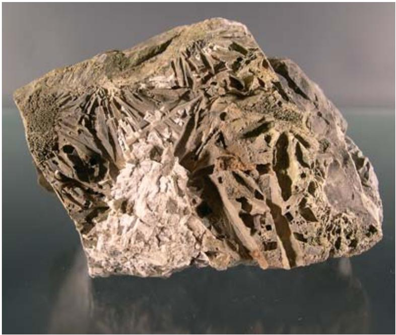
Teil des Coelestins ist in den oberflächennahen Bereichen des Gesteins unter Hinterlassung typischer Hohlformen, mit rhombischen bis fast quadratischen Querschnitt, bereits ausgewittert (Abb. 4).
