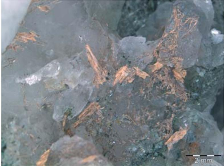
In den Quarzkristallen eingeschlossen sind noch frische, metallisch glänzende, stängelige Kristalle vorhanden, die als primäres Erzmineral, wahrscheinlich Bismuthinit, angesehen werden können. Ein Erzanschliff wurde nicht angefertigt, da die Probe zurückgegeben wurde.
