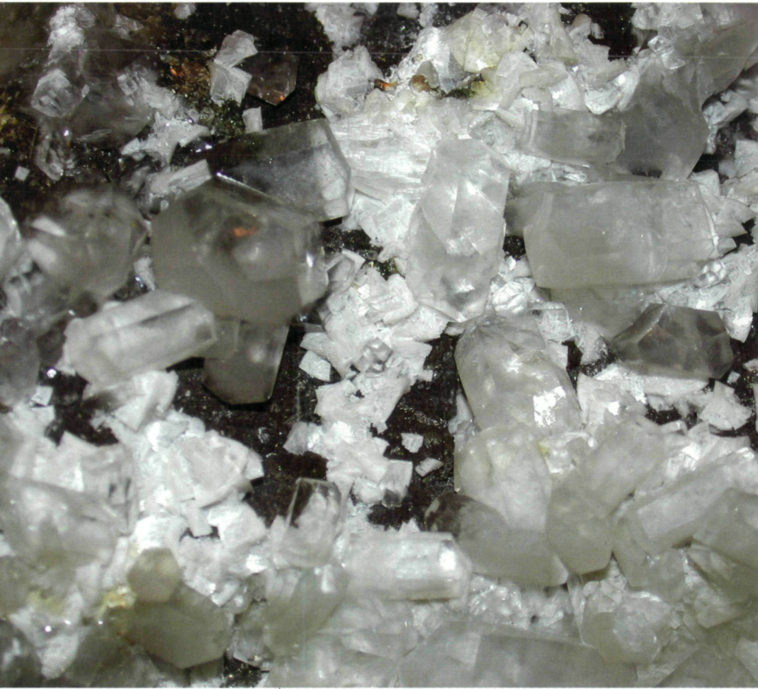
Abb. 14: Aufwachsungen von Satteldolomit (weiße Kristalle) und Kanonenspat (prismatische, transparente Kalzitkristalle) als Manifestation der Spätdiagenese. Bleiberg, Grube Stefanie, 13. Lauf (Sammlung: H. PRASENIK).
