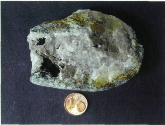
Abb. 8: Gesteinsprobe des anstehenden Felsuntergrundes aus der Tiefe von 69 m mit Korrosionslöchern. Foto: Klaus Allesch
