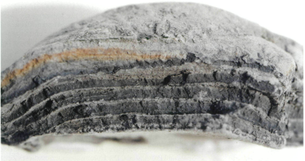
Abb. 10: Bändertonartig geschichtetes Sediment aus der Tiefe von -27,75 m. Die Dicke der Schichtenpaare heller und dunkler Lagen schwankt zwischen 1,5 mm und 5 mm. Foto: Adolf Fritz
