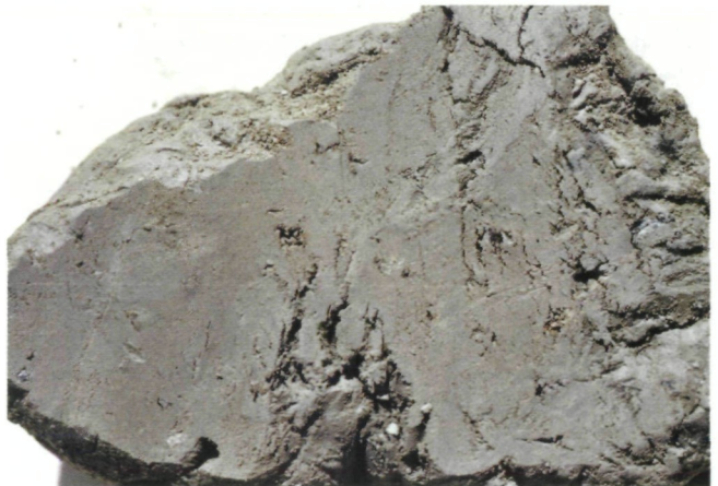
Abb. 9: Hochglaziales Stillwassersediment aus der Tiefe von 60,75 m als Aus- druck geringer Wasserführung im Talbecken. Foto: Adolf Fritz
