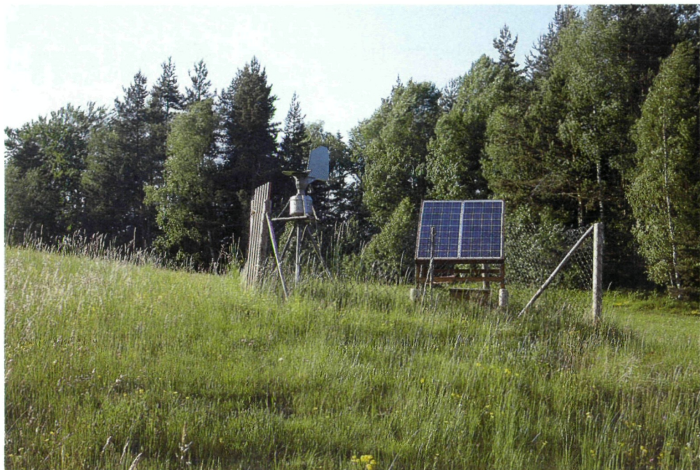
Abb. 3: Die mit Solarenergie betriebene Pollenfalle auf dem Sattnitz-Plateau (Foto: H. Zwander)
