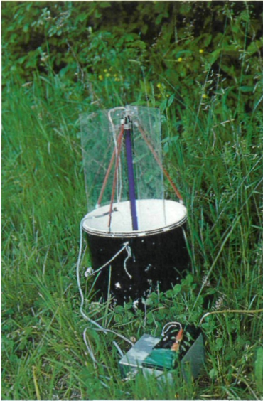
Abb. 33: Eimerfalle mit 8 Watt Schwarzlichtröhre als Lichtquelle, besonders zur Erfassung der Schmetterlingsfauna schwer zugänglicher Speziallebensräume geeignet. Foto: C. Wieser
