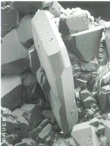
Abb. 6: Etwa 0,3 mm großer, tafelförmiger Brookit über Rasen von Albit aus dem Pilotstollen des Sem- meringbasistunnels, Steiermark. REM-Aufnah- me. Bildhöhe: ca. 0,55 mm.
