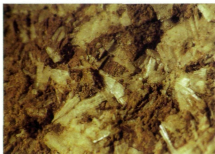
Abb. 1: Dachiardit auf limonitischer Matrix, Zeiselberg bei Klagenfurt. Bildbreite 5 mm. Sammlung und Foto: NHM Wien.
