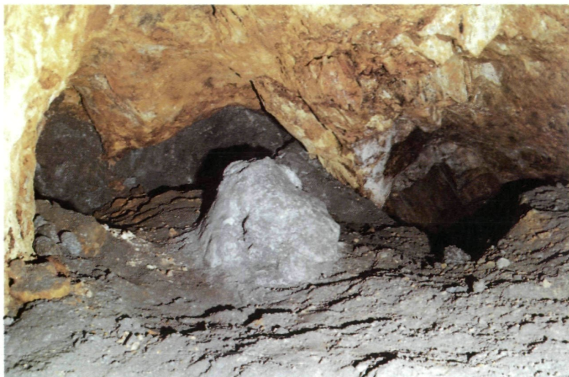
Abb. 1: Feldort im Kiesbergbau Lading: Der obere Bereich entspricht CANAVALS Beobachtungen vor der Jahrhundertwende. Auf der Stollensohle liegt das Abraummaterial, hauptsächlich Pyrit; er ist weitgehend zu Grus zersetzt. Die graue Kuppe in Bildmitte führt Eisensulfate, in ihrem Kern insbesondere den Römerit. Aufnahme: M. PUTNER
