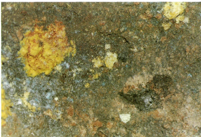
Abb. 2: Profildarstellung vom verwitternden Abraummaterial im Kiesbergbau Lading: Der graue Pyrit-Gras umschließt Aggregate von gelbem Hydronium-Jarosit, blauem Siderotil und rosarotem Römerit. Aufnahme: M. PUTTNER
