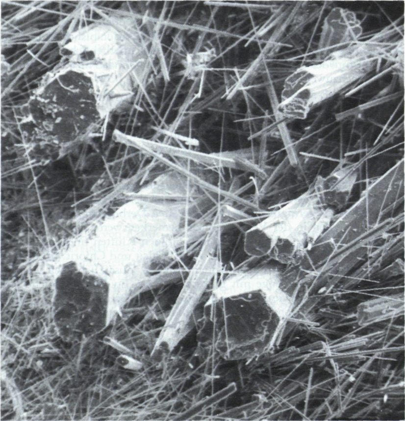
Abb. 3: Asbestartiger Nadelfilz von Beryll aus dem Gunggltal. REM-Aufnahme; Vergrößerung 100fach; Foto: Zentrum für Elektronenmikroskopie Graz.
