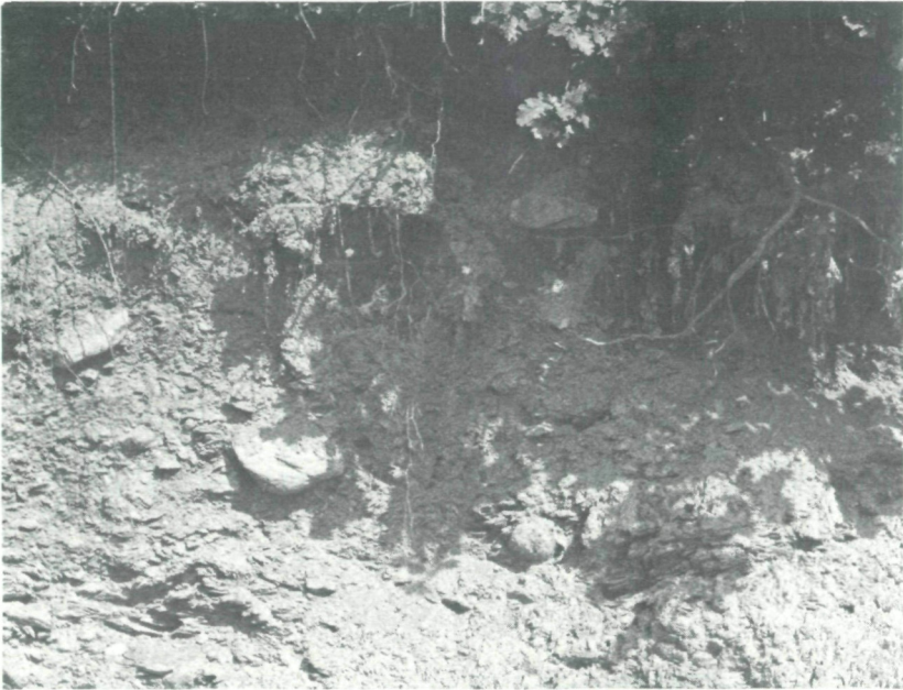
Abb. 2: Ein Aufschlußtyp (Anschnitt durch Güterwege), auf dem ein guter Teil der Kartierung in der Frage der Festgesteinsabgrenzung aufbaut. Erläuterung siehe Text. Standort S Dragelsberg.
