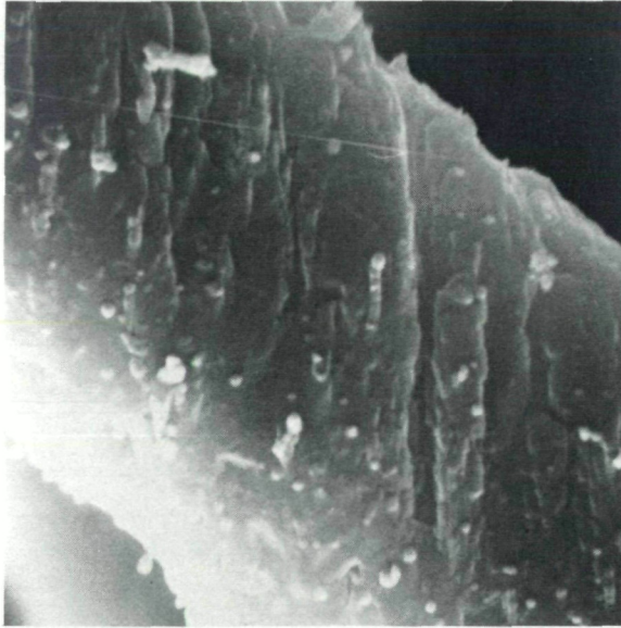
Abb. 3: Rund 6000fache Vergrößerung einer Calcit-Faser von Lausdorf. Oberfläche mit schrägliegenden Calcit-Kristalliten von etwa 0,001 \times 0,0003 mm Größe bedeckt. Vergl. auch Abb. 5.
