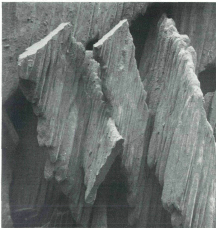
Abb. 7: Detail aus der Abb. 6, ca. Mitte links. Die Ursache der Streifung ist nun deutlich erkennbar. Die glatten, hellen Flächen links oben sind Calcit-Spaltflächen nach (10\bar{1}1) . Vergrößerung 150fach.
